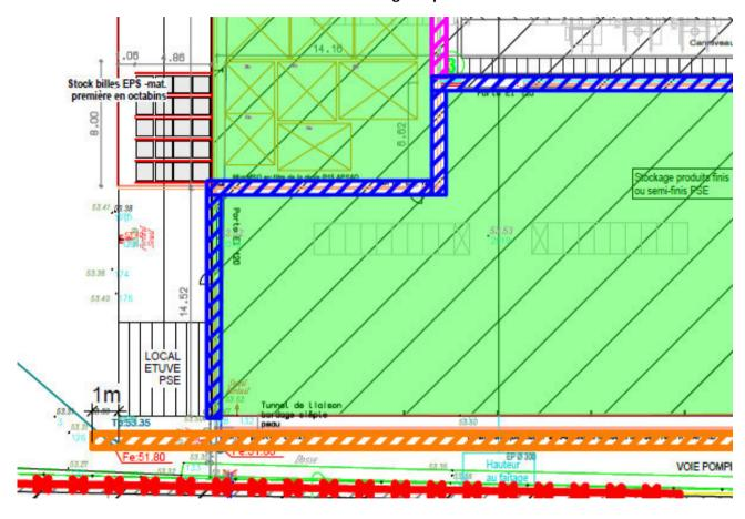
Nouvelle disposition du stockage de matière expansible EPS en 2 zones sous l'auvent entre le bâtiment principal et l'espace modulaire de stockage de 600 m²:
